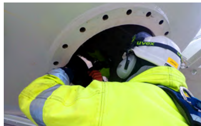
Inspektion av ett nytt kolfilter till den nya klorprocessen som ska rena saltlösningen.
