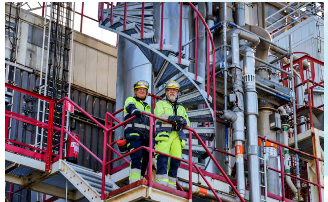
En av våra strippingkolonner som utgör ett avdrivningssteg för oreagerad VCM.
